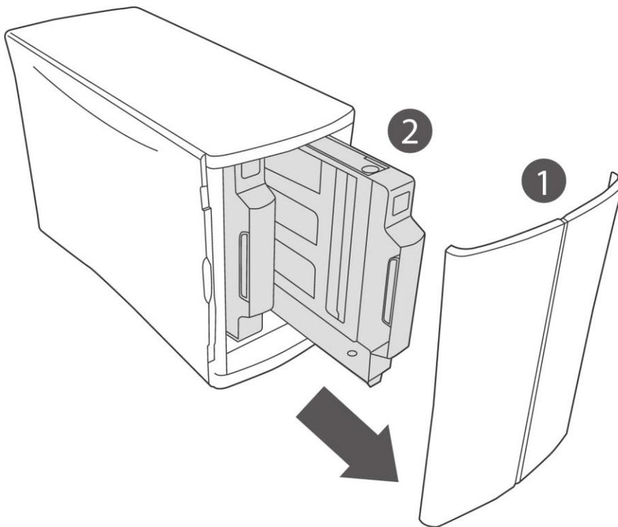
2. Installare dischi rigidi di qualità NAS (stessa capacità consigliata) nei vassoi dell'unità.
